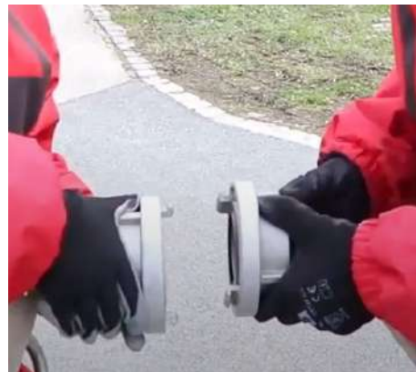
Kuppeln der Zubringerleitung
